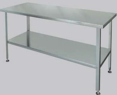
Ножки с регулируемыми опорами – оцинкованная сталь  $t=1,0$  мм, выполнены из уголка 40x40мм с подгибом краёв во внутрь. Столешница нерж.сталь, AISI 430  $t=0,5$  мм. усиление столешницы – ЛДСП (16мм). С нижней сплошной полкой. Каркас оцинкованный, стойки-уголок
