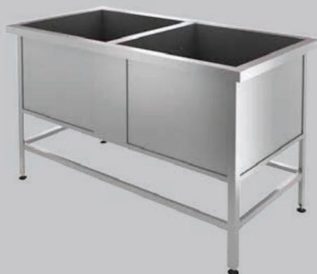
Ванна моечная **ВМ-1/600** с бортом 700x770x870, 1 ванна 600x600x450, ванна-AISI430, каркас-оцинкованная сталь, 1 отверстие под смеситель
