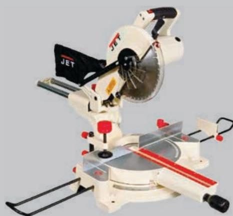
достигает 305 мм). Кроме того, возможность протягивать пилу может быть использована для нарезки шипов с края заготовки (усовки) и для выполнении глухих пазов (глубину при этом ограничивают регулируемым упором).
