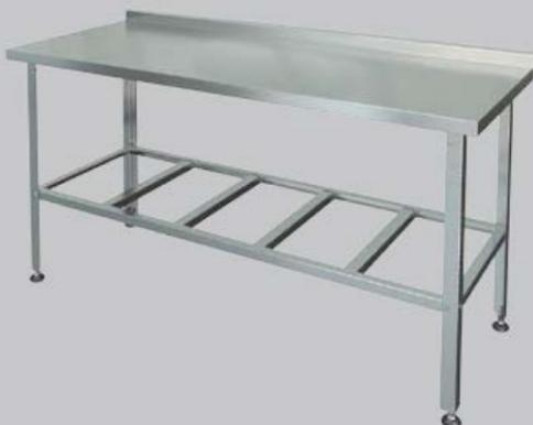
Ножки с регулируемыми опорами – оцинкованная сталь толщина 1,0 мм, выполнены из уголка 40x40мм с подгибом краёв во внутрь. Столешница нерж.сталь, AISI 430 толщина 0,5 мм. усиление столешницы – ЛДСП (16мм). Каркас оцинкованный, стойки-уголок
