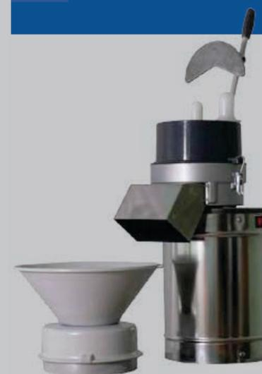
ОМ-350/220 П овощерезательно-протирочная машина
